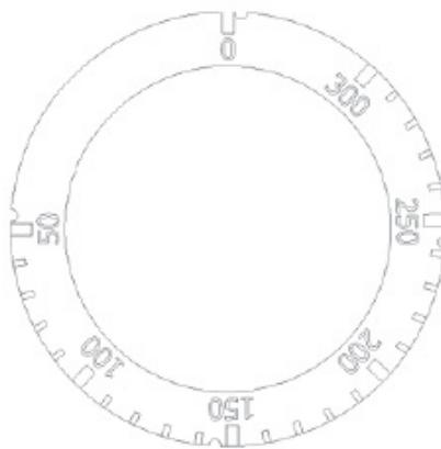
Allumez l'interrupteur situé à l'avant de l'appareil. Tourner le bouton de „0“ à la position désirée entre 50° et 300°C, les voyants blanc et vert s'allument.
